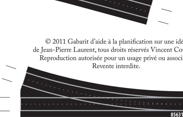
85631 : Aiguillage à droite en voie métrique, 155 mm de long, rayon 490 mm, 18° de déviation
