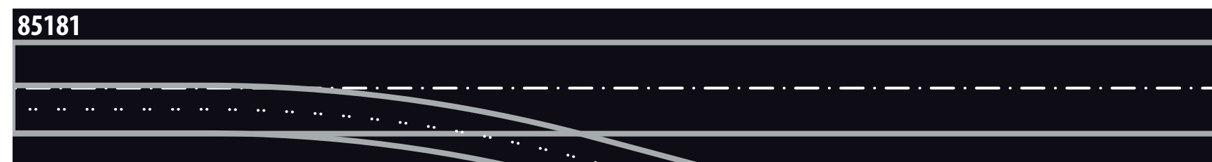
85181 : Rail droit à traverses bois avec branchement à droite d'une voie étroite imbriquée, 228 mm de long (1 unité)
