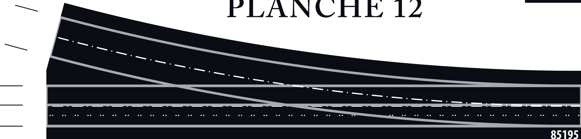
85395 : Aiguille à droite de moyen rayon avec voie étroite imbriquée directe, 228 mm de long (1 unité), 866 mm de rayon, 15° de déviation
