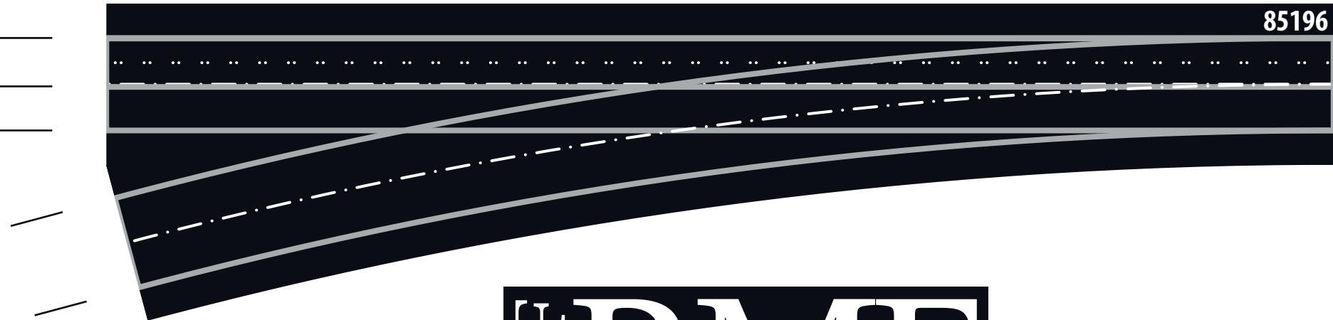
85196 : Aiguille à gauche de moyen rayon avec voie étroite imbriquée directe, 228 mm de long (1 unité), 866 mm de rayon, 15° de déviation
