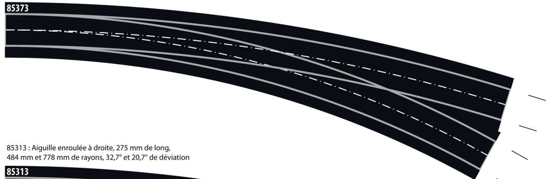
85313 : Aiguille enroulée à droite, 275 mm de long, 484 mm et 778 mm de rayons, 32,7° et 20,7° de déviation
