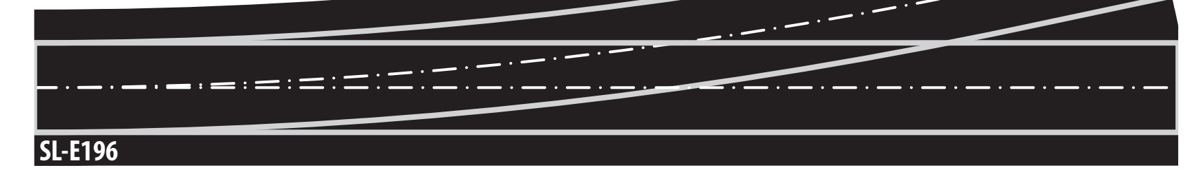
SL-E196 : Aiguille à gauche de moyen rayon, 219 mm de long, 914 mm de rayon, 12° de déviation
