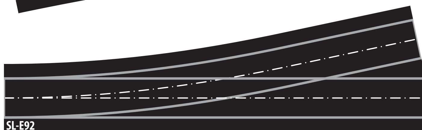
SL-E92 : Aiguille à gauche de petit rayon, 185 mm de long, 610 mm de rayon, 12° de déviation
