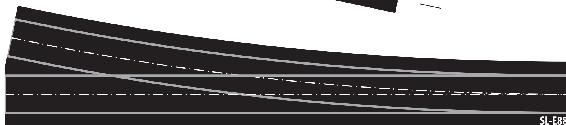
SL-E88 : Aiguille à droite de grand rayon, 258 mm de long, 1524 mm de rayon, 12° de déviation
