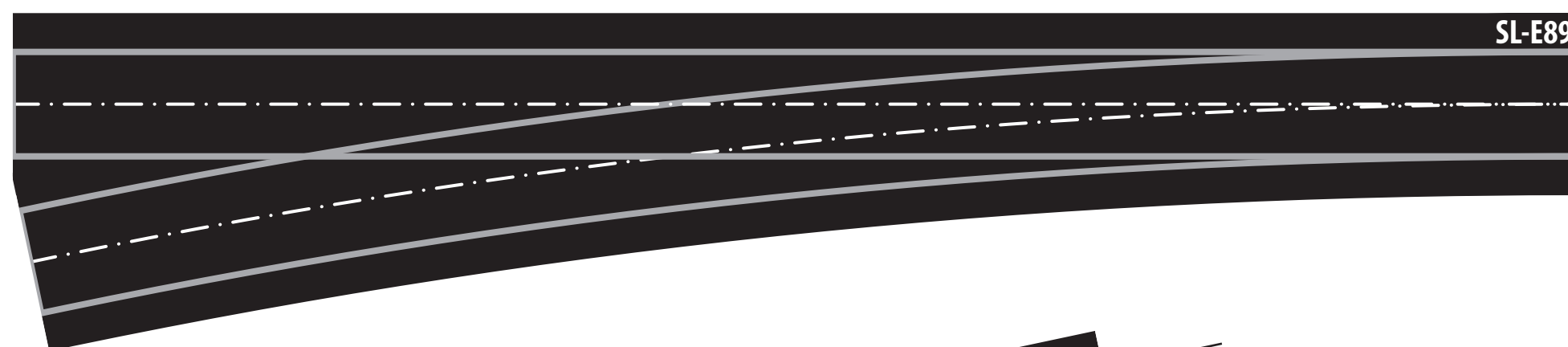
SL-E89 : Aiguille à gauche de grand rayon, 258 mm de long, 1524 mm de rayon, 12° de déviation
