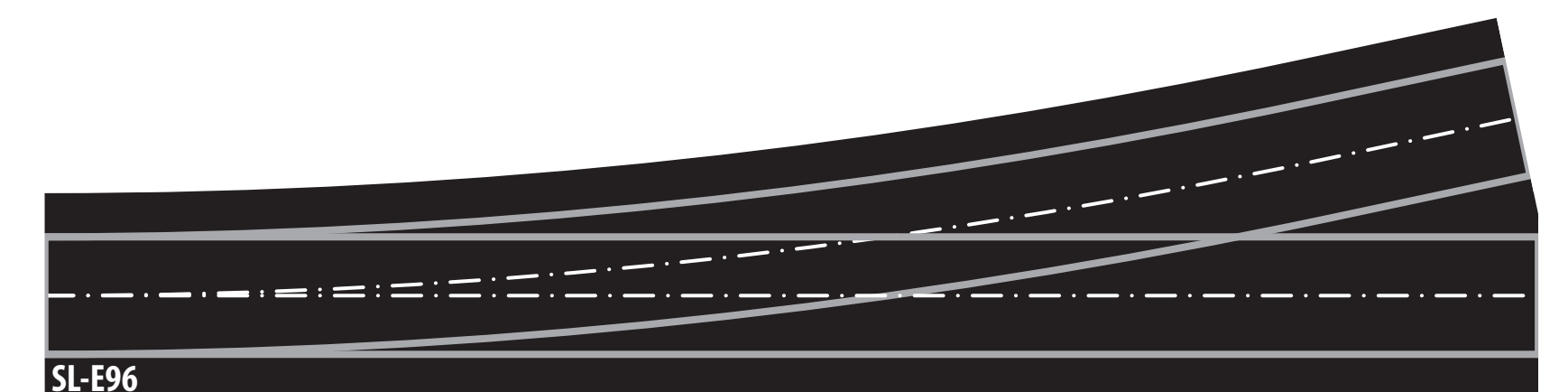
SL-E96 : Aiguille à gauche de moyen rayon, 219 mm de long, 914 mm de rayon, 12° de déviation
